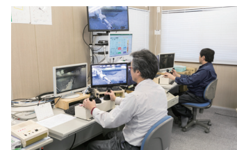
遠隔操作室から作業室のショベルを操作
