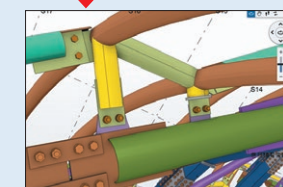
巻貝棟： 下部鉄骨とのジョイント例
