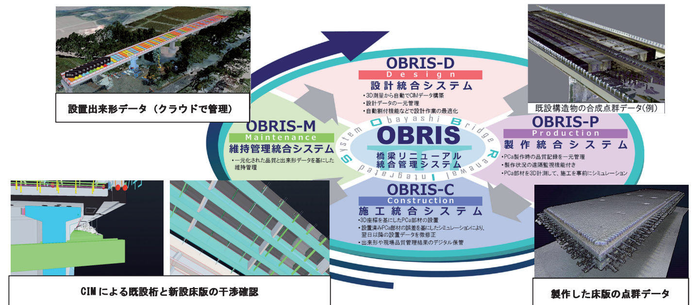
図 2: 橋梁リニューアル統合管理システム(OBRIS)
