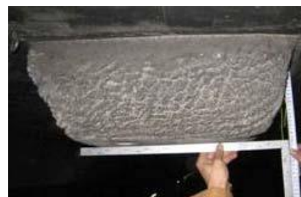
写真1 天井面厚吹き試験例 (t=200mm)
