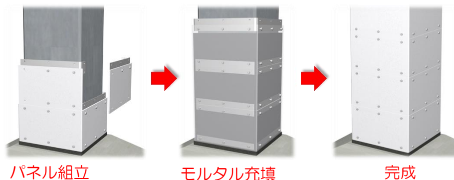
CB パネル工法の施工概念図
