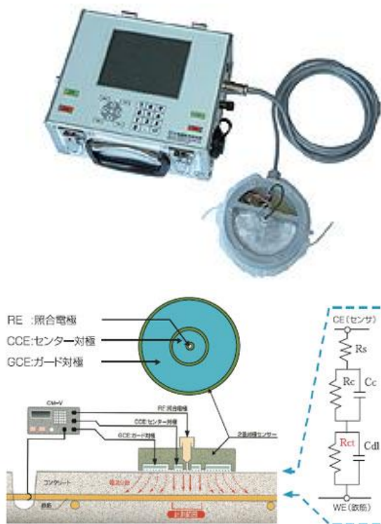
図-1 鉄筋腐食速度診断器（市販品）
