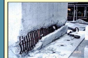
無補強(基部鉄筋のはらみ出し破壊)
