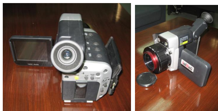
図-2 赤外線カメラ[高性能, コンパクト]（市販品）
